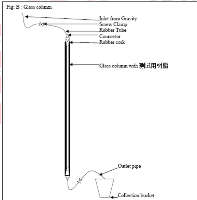
测试用的溶液样本以瓶子或烧杯填装，每次取样的时间以不超过 4Hrs 为最理想。**Tulsimer®CH-97** 离子交换树脂为大孔交联聚苯乙烯为单体，具有去除汞等杂质专用的甲基硫醇官能基。此树脂为去除汞专用树脂，其官能基对于汞等杂质离子的吸附具有很强的电子亲和力(Affinity)，因此绝大部分的汞等杂质离子都会被此树脂去除掉。测试用的溶液分别以批次分别慢慢的倒入已装填 **CH-97** 的玻璃管，来当成是连续性的采水步骤。整个汞交换反应在最上层的树脂床是最快的，直到上层 **CH-97** 的交换容量慢慢耗尽后，才由最下层的 **CH-97** 树脂继续交换其它剩余的汞等离子。因此当测试用的溶液由上往下经过树脂床时，会有一个有效的交换区，直到所有的 **CH-97** 树脂的交换容量完全耗尽为止。下图 A 显示每个交换过程。
